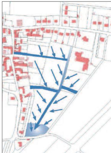
Après visite sur le site, le terrain semble disposer d'un talweg léger descendant vers le sud ouest. En respectant ces pentes, les eaux pluviales des voiries et des toitures peuvent être collectées en surface pour aboutir en partie basse du terrain dans un bassin d'infiltration traité en prairie. Cette récupération aérienne centrale est complétée par un réseau perpendiculaire de noues.
